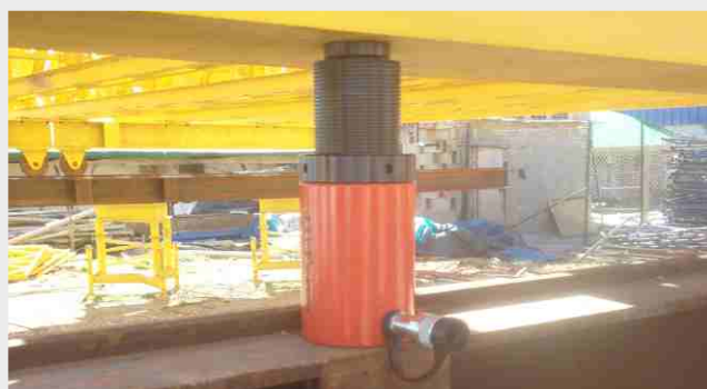
Montážní pomůcky (nahore - hydraulický zvedák, dole – JibFlex jeřábek)
